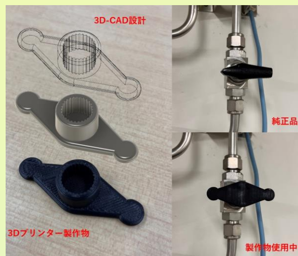
ガス管バルブの補修
