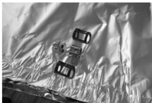
図10. イオンレンズの内部構造
