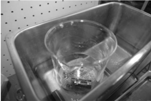
図 1 5. アセトン中での超音波洗浄
