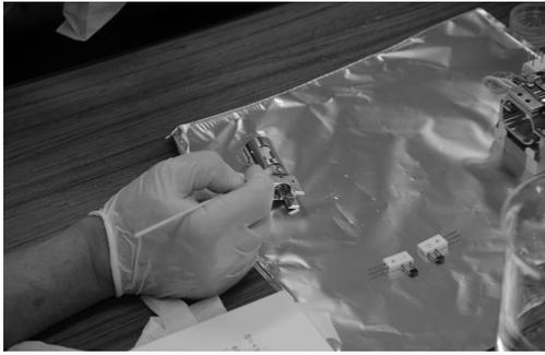
図 1 4. アルミナ粉と綿棒を使用し各部品を研磨
