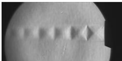
図 4.機械工学実験 II 高速気流の実験 (シュリーレン法による噴流の可視化)
