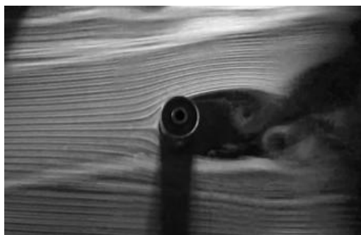
図 3.機械工学実験 I の円柱周りの流れ (スモークワイヤ法による可視化)
